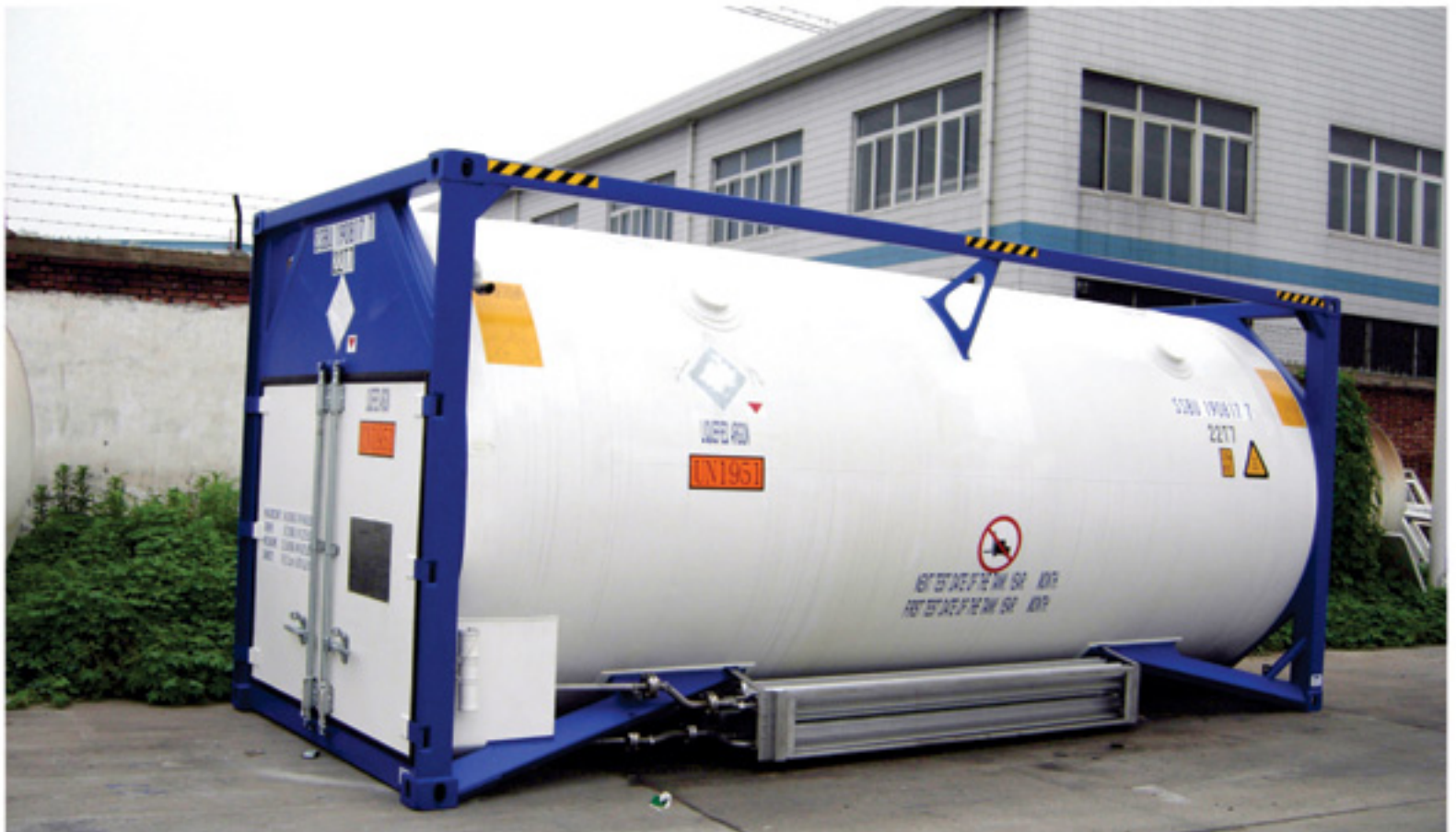
20 Feet ISO Container for LAR, LNG
